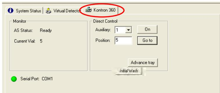
Fig. 243 Kontron Autosamplers status tab
