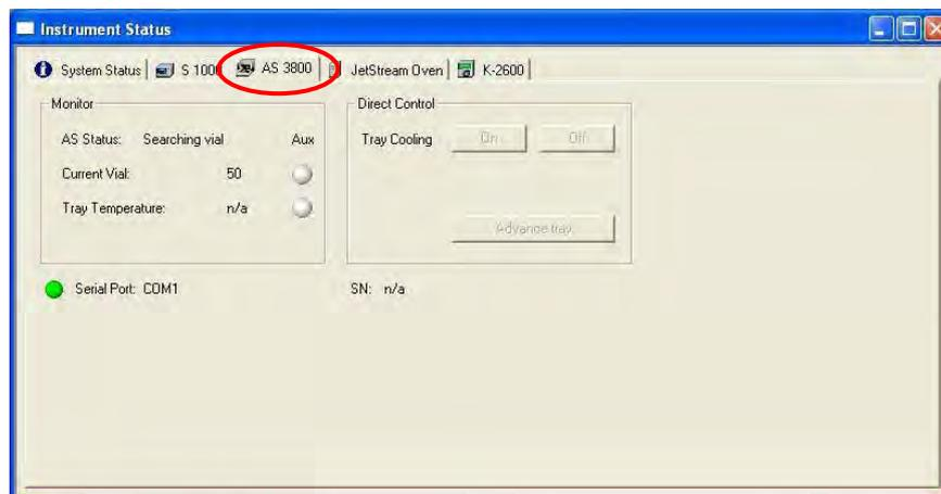
Fig. 239 Autosampler 3800 status tab
