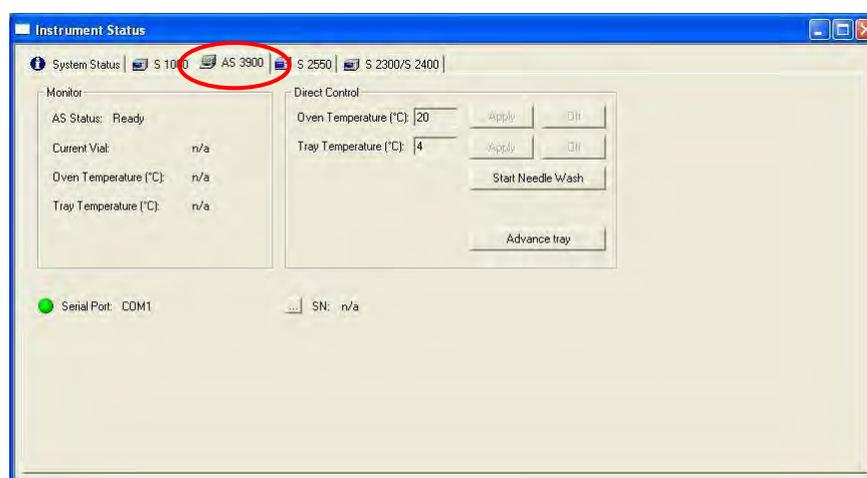
Fig. 240 Autosampler 3900 status tab
