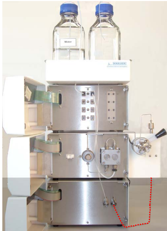
Abb. 11 Kapillaranschluss des Detektors
