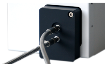
Fig. 20 Fibre optique sur le détecteur
